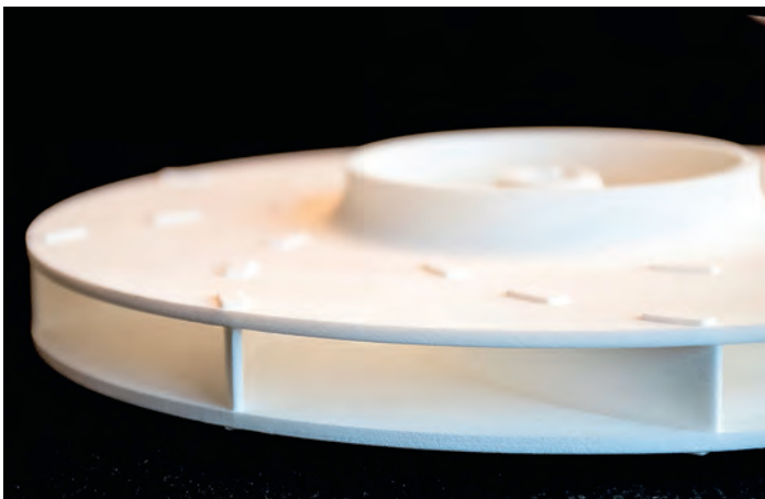
Kleinkalierte Prototypen-Laufkörper, hergestellt durch Selektives Lasersintern in Kunststoff, werden bei Elektror für Messungen mit bis zu 18 000 min -1 betrieben.
