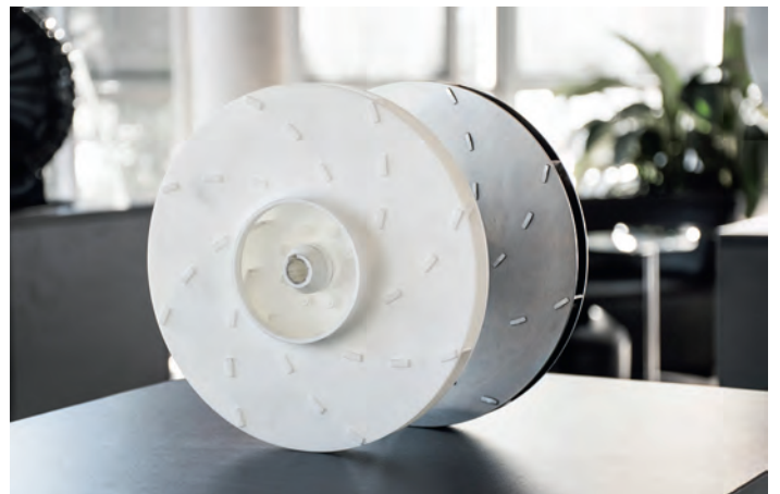
Um einen nennenswerten Einfluss des Materials auszuschließen, werden Messungen von identischen Laufkörpern aus Aluminium und aus Kunststoff durchgeführt.
